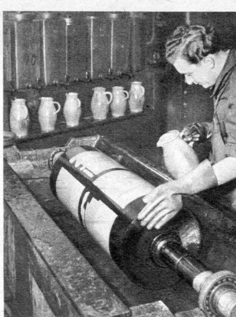
In der Ätzerie. Große Kupferzylinder sind die Druckträger. Nachdem die Seiten foto-technisch auf einen Zylinder übertragen wurden, wird mit Säure das Bild in das Kupfer hineingeätzt. Die bild- und druck-freien Stellen sind mit Asphaltlack abgedeckt.
