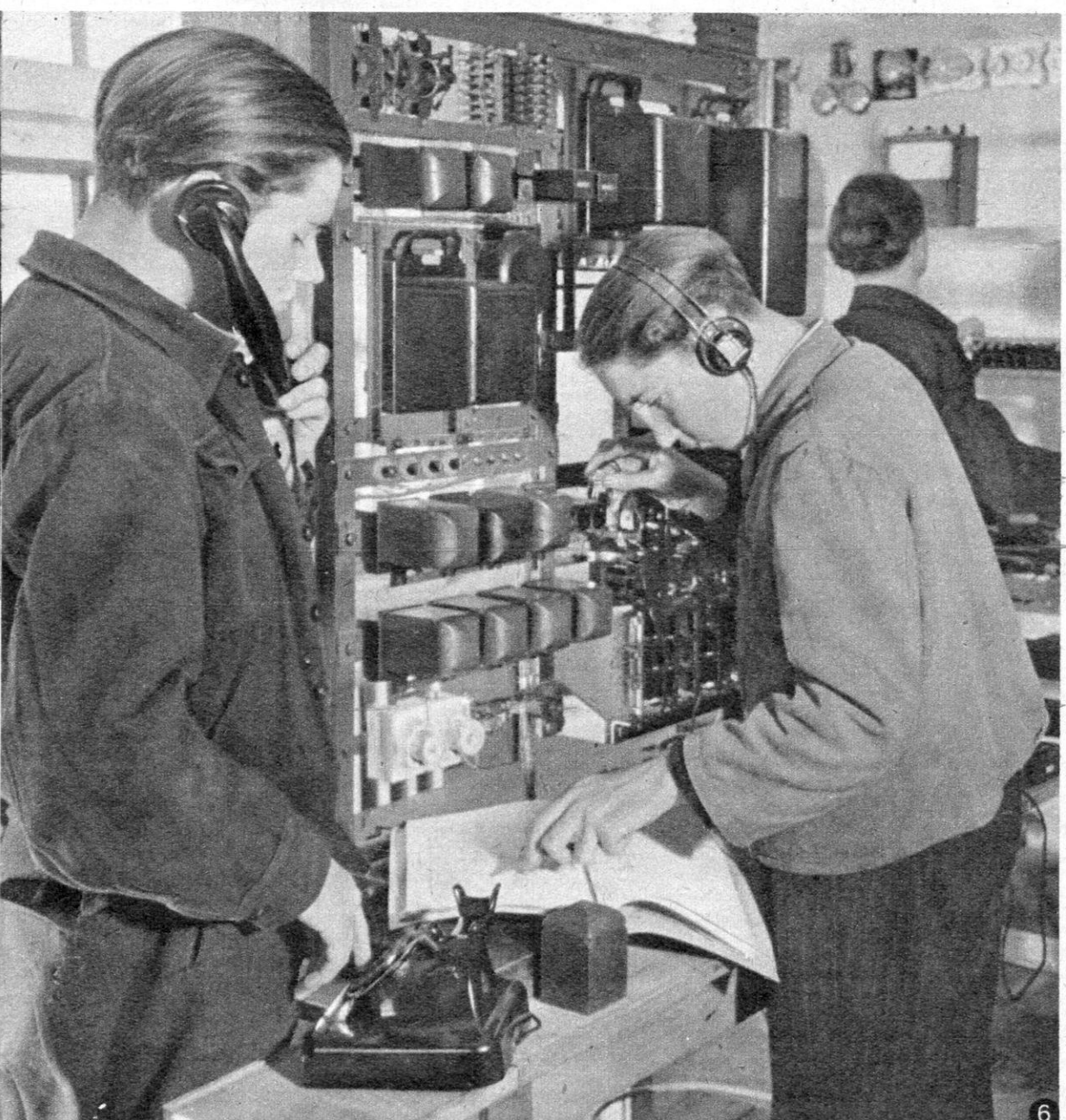
5 Ausbildung in der Schaltungstechnik. Der Laie sieht nur verwirrende Linien mit geheimnisvollen Bezeichnungen. Im dritten Lehrjahr weiß man aber, daß es sich hier nur um eine Nebenstellenanlage handeln kann.
