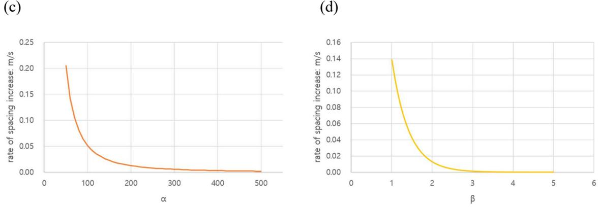
**FIGURE 5.5 Sensitivity analysis of  $k_{in}$  (a)  $k_{in}$  versus  $\alpha$ ; (b)  $k_{in}$  versus  $\beta$ ; (c) spacing increase versus  $\alpha$ ; (d) spacing increase versus  $\beta$**
