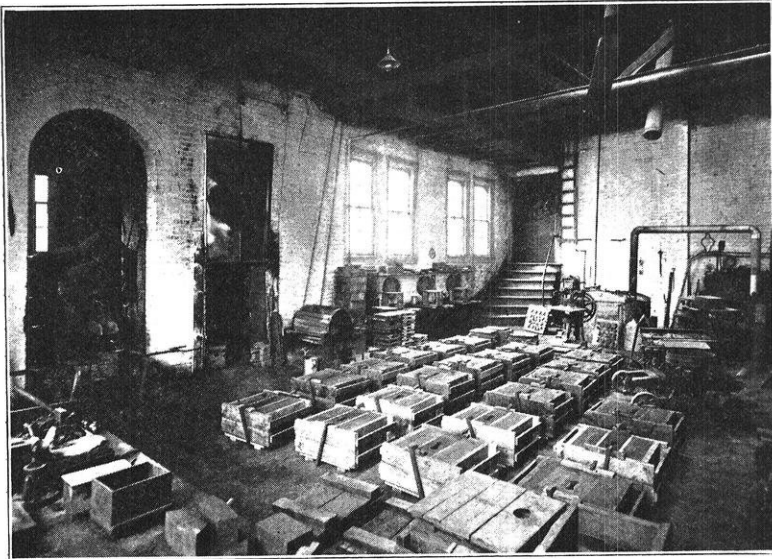
Ready to Pour in the Foundry
