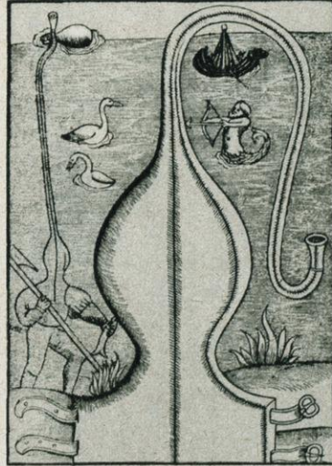
Eine der ersten gedruckten Zeichnungen von einem Taucherhelm. Er sollte aus Leder verfertigt werden und eine lange Luftröhre besitzen.
