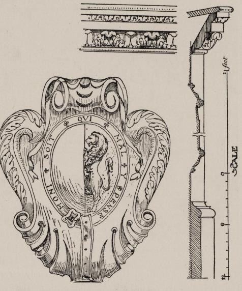
FIG. 74.—CARVED SHIELD ON DOOR IN THE CHAPEL.—H. INIGO TRIGGS del.
