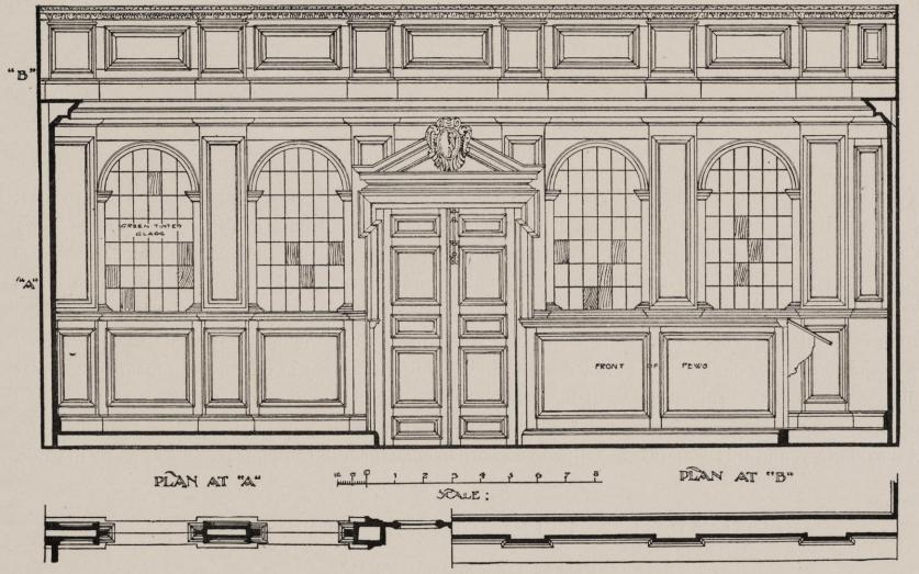
FIG. 73.-ELEVATION AND PLAN OF THE SCREEN IN CHAPEL.-H. INIGO TRIGGS del.
