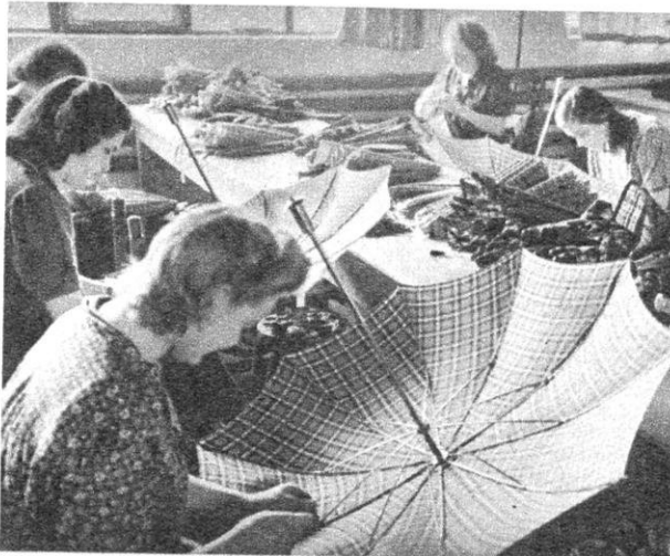
Oben und rechts: Nach einer letzten Prüfung von Schirmbezug und Schirmgestell erhält letzteres nun seinen Bezug. Ein Arbeitsvorgang, für den es noch keine Maschinen gibt und der daher ausschließlich von Hand ausgeführt wird. So ist der weltbekannte „Knirps“ entstanden. Als letzte Zugabe bekommt er unten den „Top“ aufgesetzt. Nun wäre er eigentlich fertig. Doch noch muß er „gebügelt“ werden.
