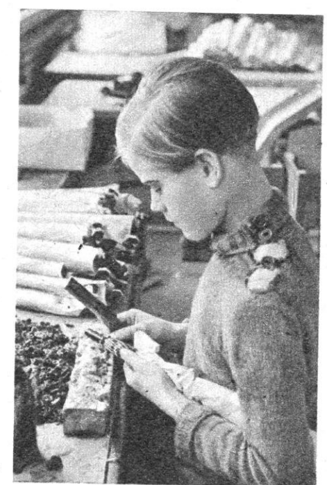
Während der Schirmbezug nach dem Zuschneiden zum Nähen einen eigenen Weg geht, ist das Gestell zusammengesetzt worden. Die Stangenenden haben Zelluloidspitzen erhalten, und der Griff wird aufgesetzt.
