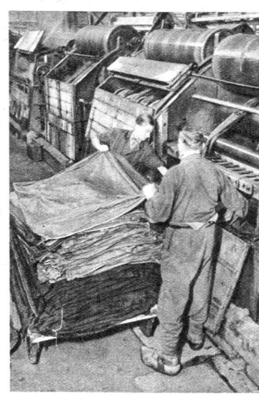
In einer solchen „Waschmaschine“ werden etwa 300 Meter Stoff bei jedem Arbeitsgang behandelt
