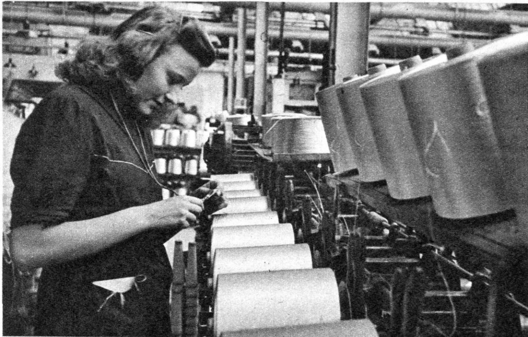
Die „Kuchen“ sind auf der Spulmaschine, wo sie zu einer konischen Form aufgespult werden. Oft reißt der Faden — und die Arbeiterin hat genug zu tun. Sie darf beim Wiederverbinden nur den „Weberknoten“ verwenden. Nun noch zum Trockenprozeß, dann fertig zum Verpacken. Dann gehen die Fäden in die weiterverarbeitende Industrie, wo viele andere fleißige Mädchenhände sie zu Bekleidungsstücken verarbeiten
