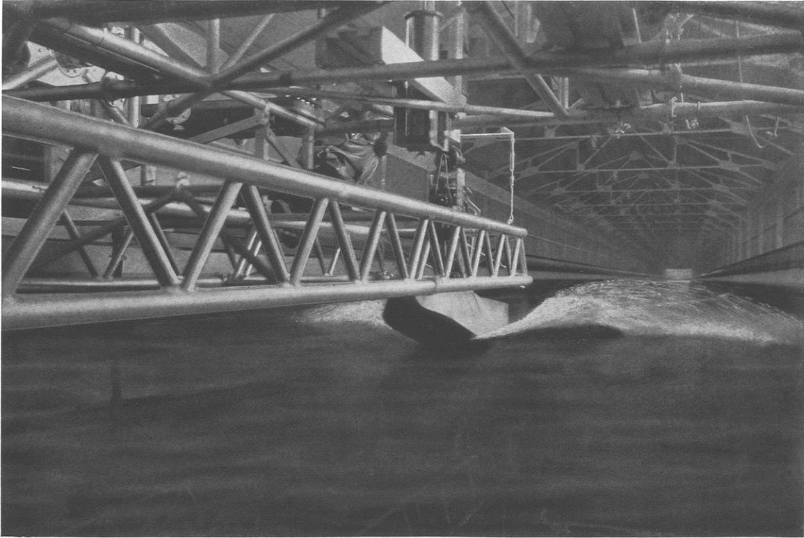
MODEL HULL UNDER TEST IN N.A.C.A. TANK
