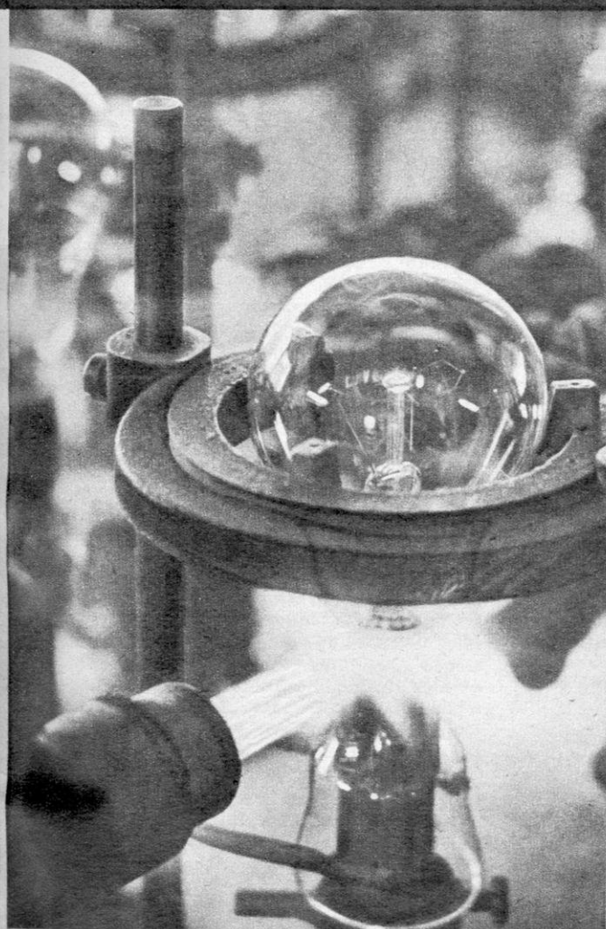
(Rechts): Der nun fertige Lampenkörper wird luftleer gepumpt, zuerst mit einer Grobabbumpung, dann folgt im geschlossenen Kasten dahinter die Feinabbumpung. Ebenso unter genauen Kontrollen wird der Lampenkörper mit Edelgas gefüllt. Die Gasfüllung geschieht aber nur bei Birnen von 40 Watt und bei höheren Einheiten.
