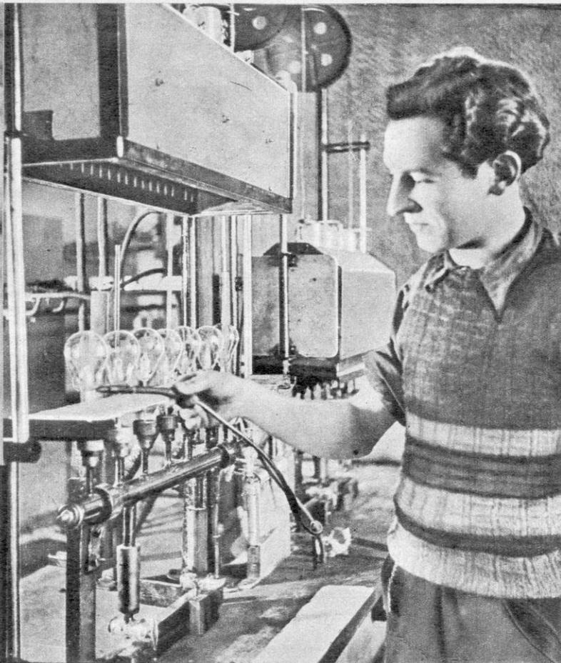
Nun kann die Lampe zum ersten Male aufleuchten, noch ohne Metallsockel, nur mittels der beiden freiliegenden Elektroden. Man nennt dies „klarbrennen“. Nach dieser Prüfung wird der Sockel aufgesetzt, und nach noch zweimaliger Brennkontrolle wird die fertige Lampe verpackt und ist versandfertig.
